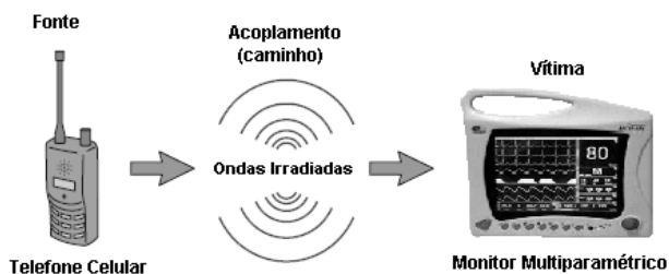
Figura 1: Interferência eletromagnética irradiada. Ocorre quando há a presença simultânea de fonte, acoplamento e equipamento vítima.
